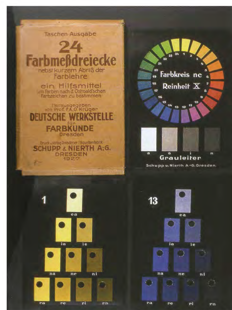
Die Deutsche Werkstelle für Farbkunde gab in Ergänzung zu Ostwalds „Wollatlas“ von 1925 bis 1928 auch Referenzkarten für Textilausfärbungen heraus (Bild oben) sowie Farbmaßdreiöcke u. a. Hilfsmittel nach Ostwald Farbnormen (Bild unten)
