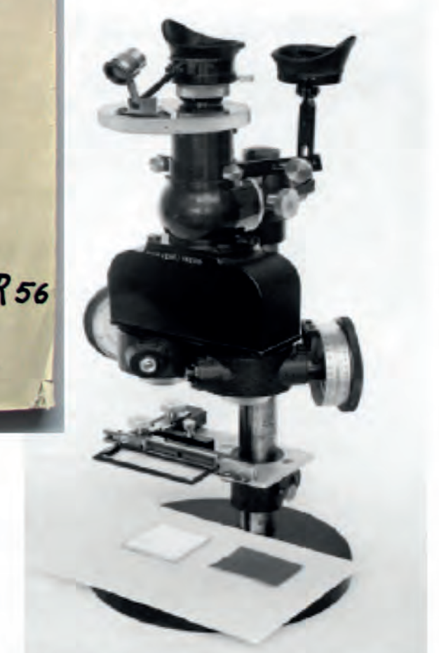
Richters Dissertationsschrift (1937) und das von M. Richter umgebaute Pulfrich-Fotometer zur Bestimmung von T und S (1953)
