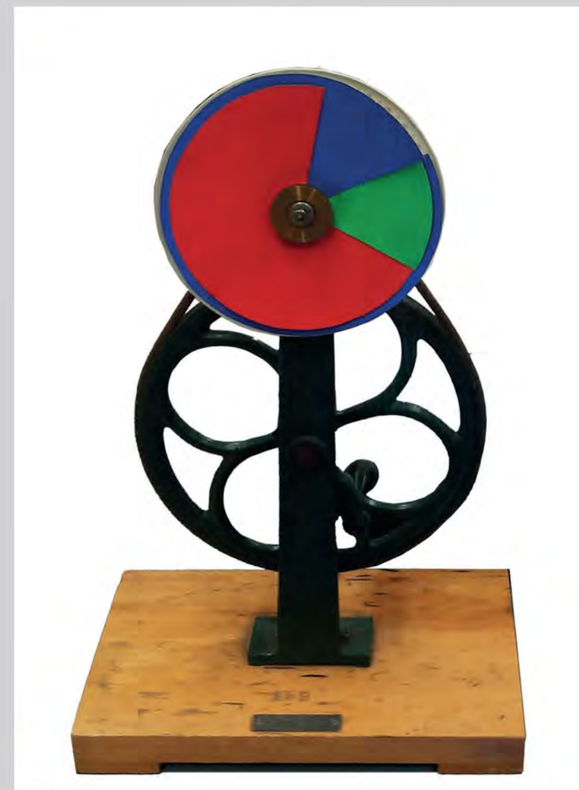
rechts: Klughardts „Integrator“ zur Ermittlung von Farbvalenzen unten: Mit Baumann-Prase-Farbaufstrichen bestücktes Kreisgerät aus Klughardts Farbforschungslabor
