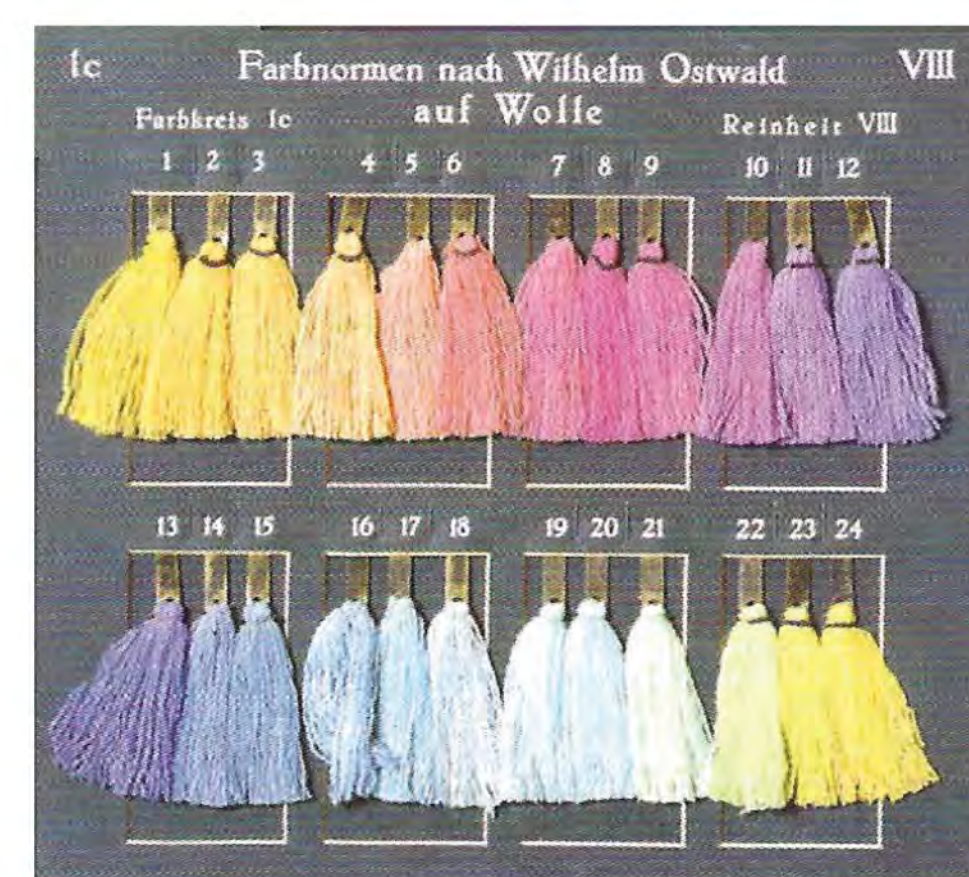
Die Deutsche Werkstelle für Farbkunde gab in Ergänzung zu Ostwalds „Wollatlas“ von 1925 bis 1928 auch Referenzkarten für Textilausfärbungen heraus (Bild oben) sowie Farbmaßdreiöcke u. a. Hilfsmittel nach Ostwald Farbnormen (Bild unten)
